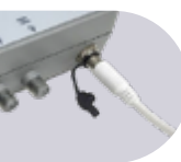
Fuente redundante conectada
